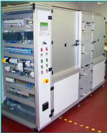
Foto: Beispiel für einen Hochleistungsbrennstand für Sonderlampen
