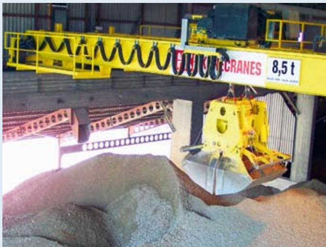
Bild: Automatisierter Prozesskran im Rohstofflager eines Zementwerkes
