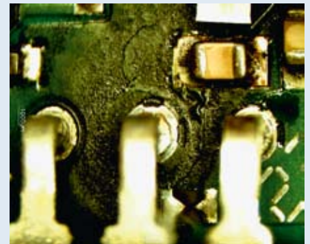
Elektromigration an einer elektronischen Baugruppe
