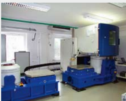
Bild: Zwei Schwingprüfanlagen mit Temperaturüberlagerung
