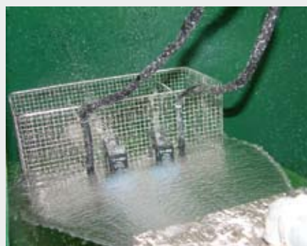
Bild: Schwallwasserprüfung nach Automotive-Anforderungen
