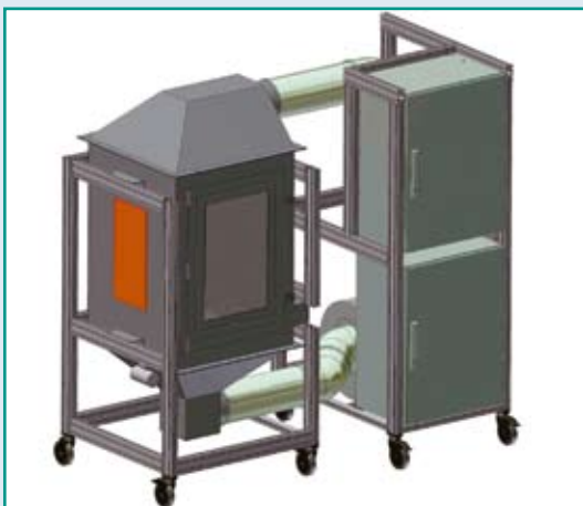
Abbildung: Darstellung der modularen Staubprüfeinrichtung mit wechselbarem Prüfraum
