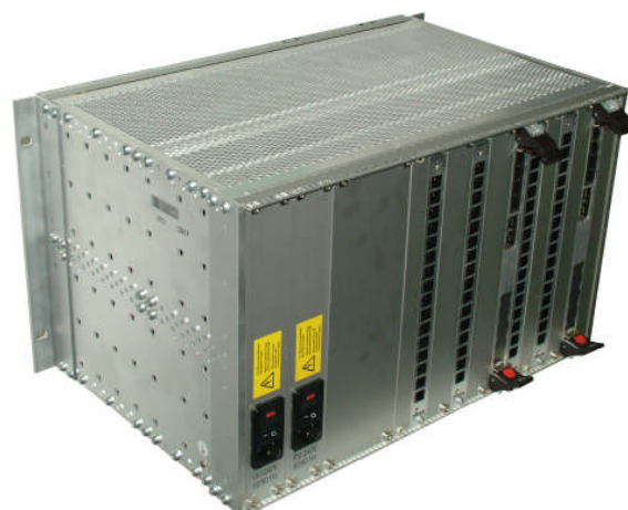
Rückansicht mit RJ11-Fernwirk- und RJ45-LAN-Anschlüssen
