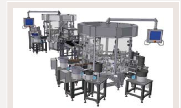
Für EAW Relais-technik in Berlin entwickelten wir eine komplette Montage- und Prüflinie. Die Anlage fertigt vollautomatisch Thermoschalter für die verschiedensten Anwendungen in Industrie und Haushalt.
