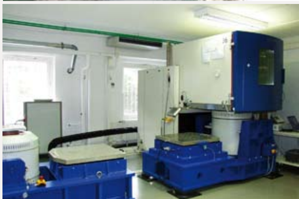
Oben: Schwallwasserprüfung nach Automotive-Anforderungen Unten: Zwei Schwingprüfanlagen mit Temperaturüberlagerung
