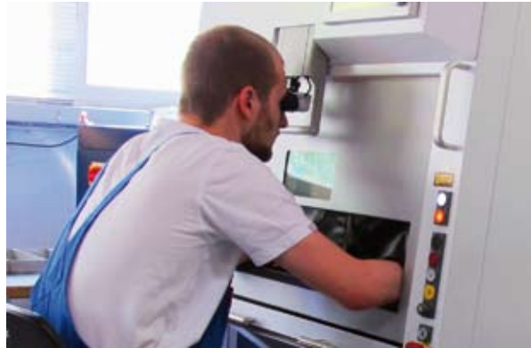
Schweißen an der TruLaser Station 5004
