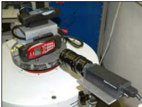
Bildüberwachungssystem für mechanische Prüfungen: „Schwinger mit Kamera“
