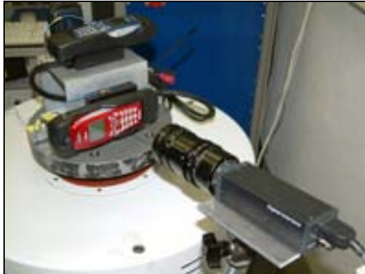
Bildüberwachungssystem für mechanische Prüfungen: Schwinger mit Kamera.
