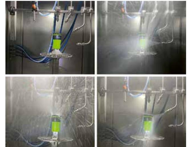
IPX9/IPX9K-Kammer in Aktion: Innenansicht mit Prüfling (oben links) sowie Dampfstrahl bei 0° (oben rechts), Dampfstrahl bei 30° (unten links) und Dampfstrahl bei 60° (unten rechts)
