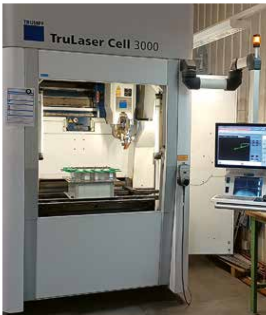
Bild links: TruLaser Cell 3000 in der AUCOTEAM-Fertigung
