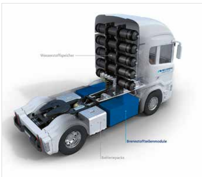
Wasserstoffspeicher an einem Lkw
