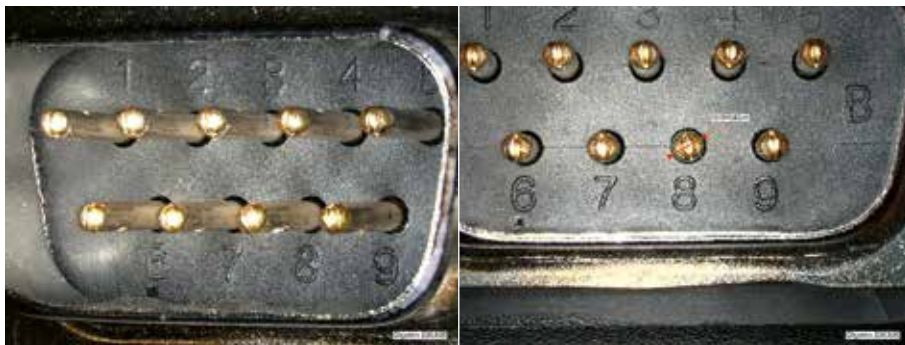
Fotos oben: Vermessung des Kontakt-Durchmessers eines handelsüblichen D-Sub-Steckers Fotos rechts: Vermessung der Breite eines Kratzers auf einer 1 € Münze
