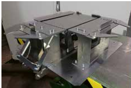
Schweißvorrichtung im CAD und als reale Baugruppe
