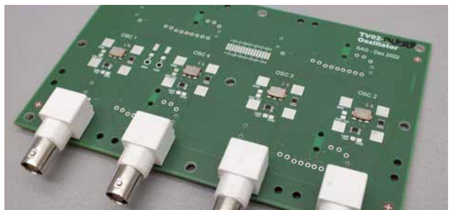
Testbaugruppe mit Oszillatorschaltung (Siemens)
