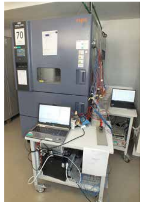
Temperaturschockkammer mit Ansteuerungs- und Messtechnik
