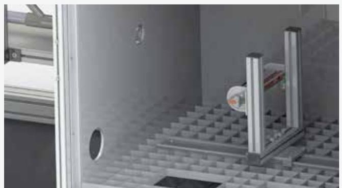
Innovative Prüflingaufnahme zur Einstellung des Winkels und Abstands in Abhängigkeit von der Prüflinggeometrie
