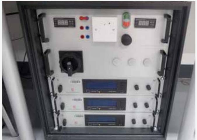
Prüfrack zur Steuerung der elektrischen Leistung und Überwachung der Prüfräume
