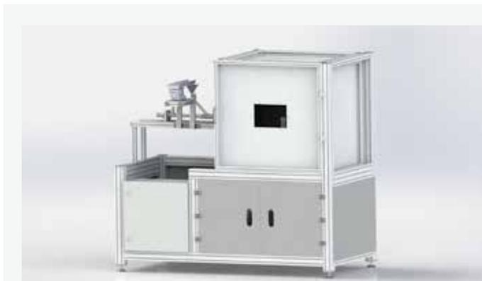
CAD-Modell des Steinschlagsimulationsprüfstands
