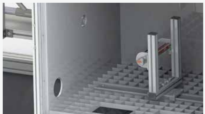
Innovative Prüflingaufnahme zur Einstellung des Winkels und Abstands in Abhängigkeit von der Prüflingengeometrie
