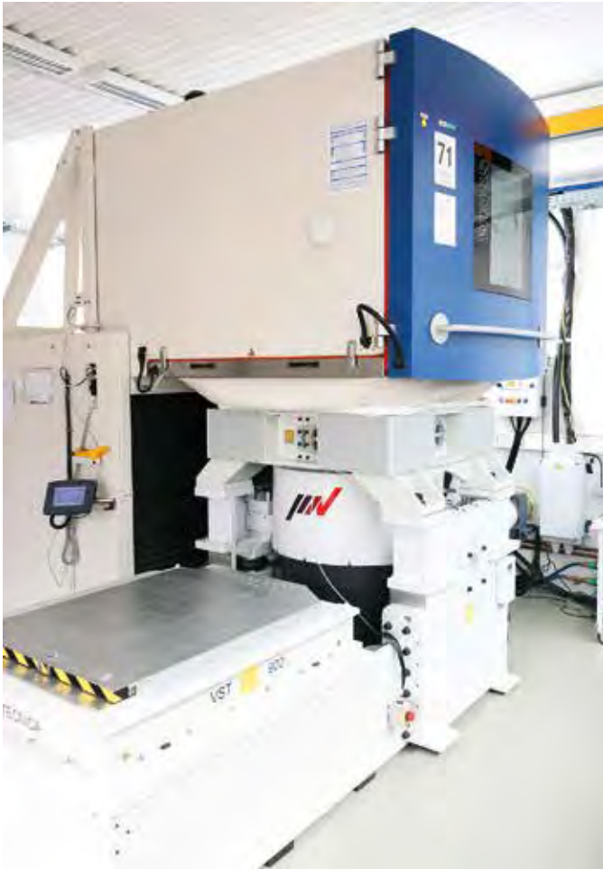
74 kN IMV Shaker mit Schwerlastplattform und Klimakammer während einer Vibrationsprüfung mit Temperaturüberlagerung
