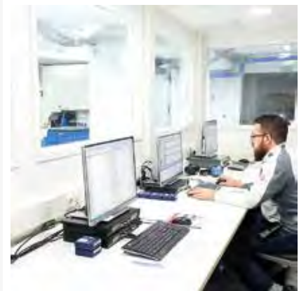
Leitwarte mit großen Fenstern zur Regelung von vier Schwingprüfanlagen
