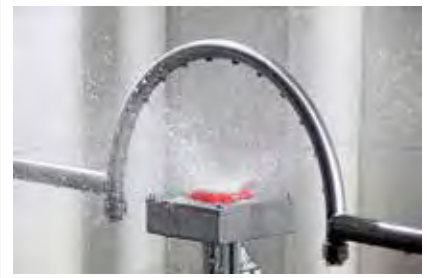
Spritzbogen (IPX4 Prüfungen)
