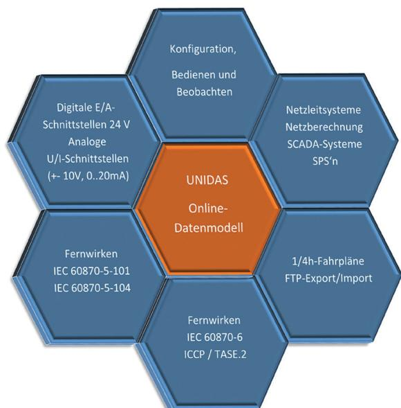
Das **UNIDAS Datengateway** ist auf einer sehr leistungsfähigen Hardware realisiert und läuft als Applikation unter dem stabilen und bewährten Echtzeit-Betriebssystem VxWorks 7. Es besteht aus skalierbaren und modular verwendbaren Funktionsmodulen, die je nach Anwendungsfall in der Firmware des jeweiligen Systems integriert werden. Das System bietet komplexe, vielseitige und flexible Kommunikationsmöglichkeiten und Datenverarbeitungsfunktionen.
