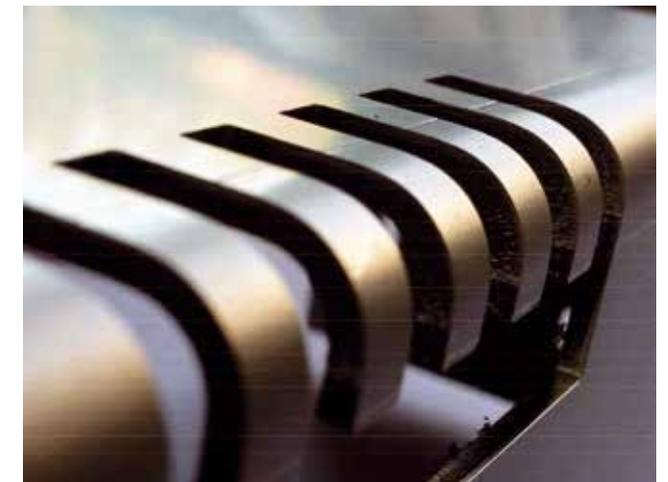
Bild: Ausbruch läuft scharf um die Biegekante – nachträglich lasergeschnitten
