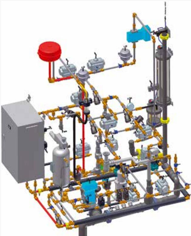
Bild: Hydrauliksystem des Prüfstandes
