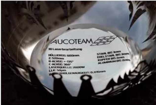
Bild: Muster aus der Feinblechbearbeitung mit 3-D Laser
