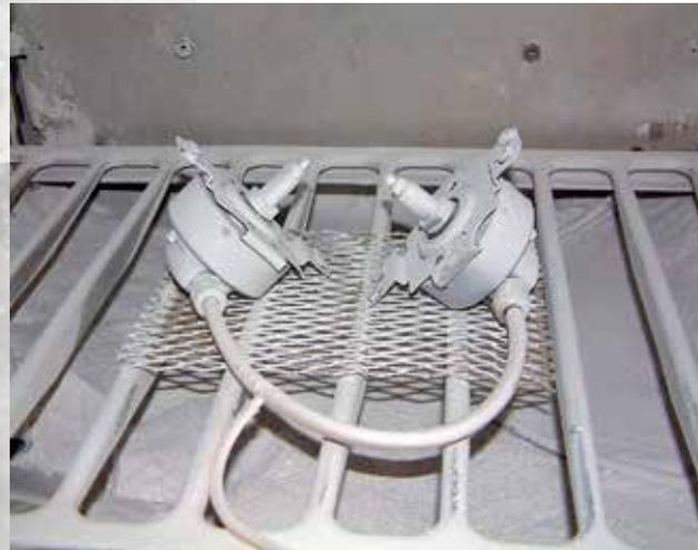
Bild: Geber in der Staubkammer mit Talkum nach DIN 60529
