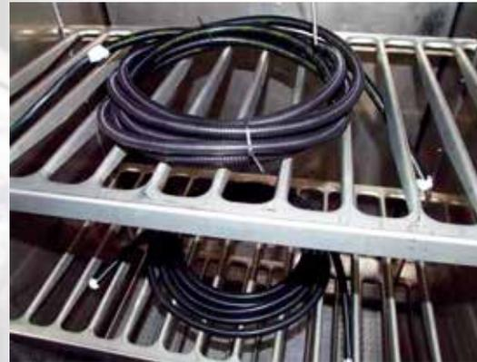
Bild: Leitungen für die Bahn in der Klimakammer
