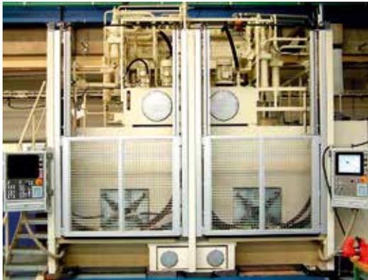
Ein Beispiel für die erfolgreiche Zusammenarbeit: Im tschechischen Chomutov nahm AUCOTEAM einen Prüfstand für Zahnradpumpen und -motoren in Betrieb. Er hatte den „Start of production“ in der Serien-Endprüfung mit großem Erfolg bestanden.
