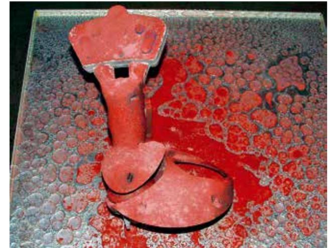
Bild: Staubschutzprüfung mit Arizona Staub nach Automobilnorm
