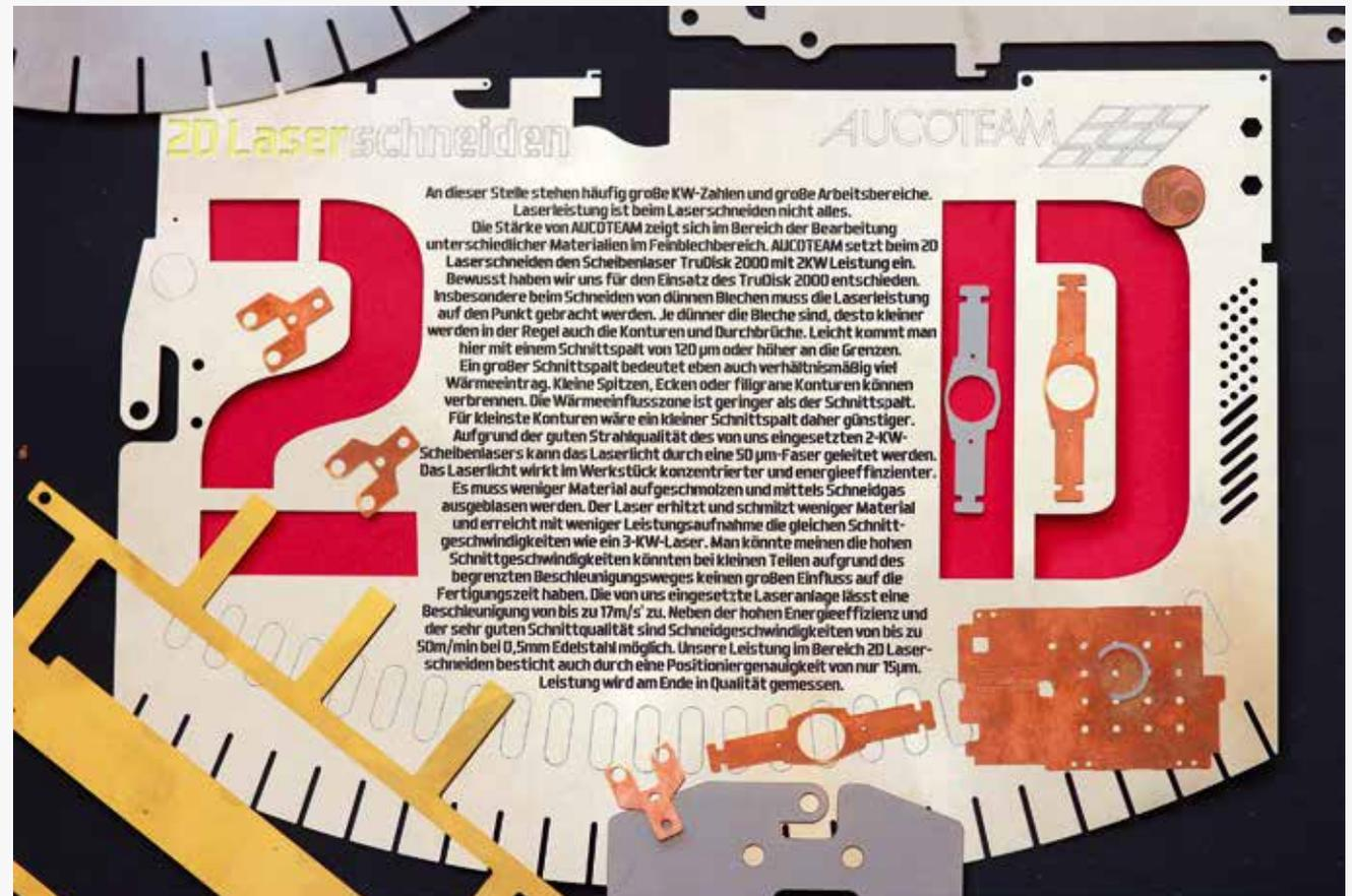
Bild: Muster aus der Feinblechbearbeitung mit 2-D Laser. Alles Wichtige ist auf dem Blech beschrieben.
