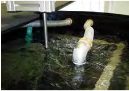
Temperiertes Wasser von 0°C bis +3°C für die Schwallprüfung
