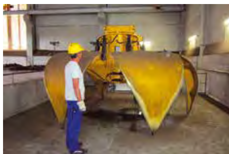
Ein Lagermitarbeiter inspiziert den Reservigreifer. Die Automatisierungslösung wird von den Mitarbeitern gut akzeptiert.
