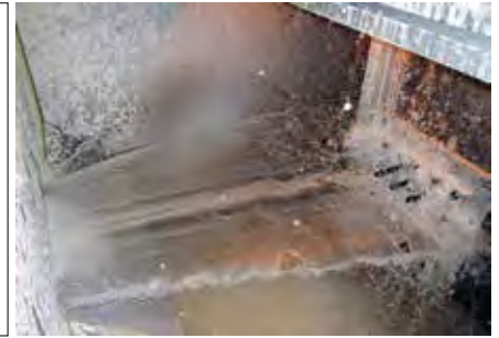
Schwallvorgang mit 2°C kaltem Wasser / 70 l pro min
