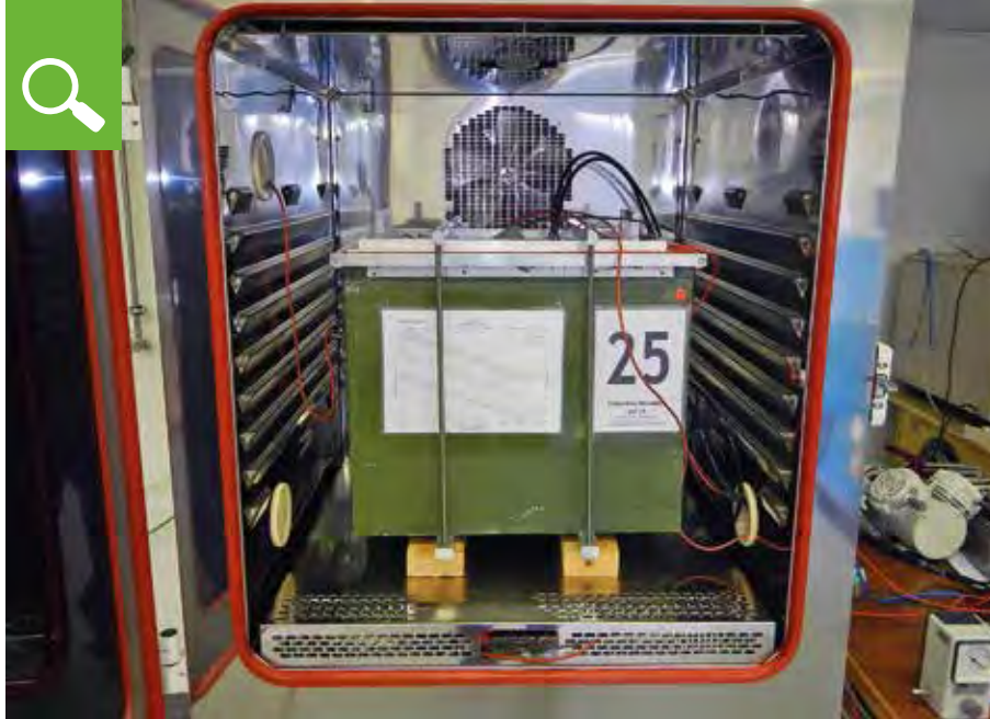
Foto: Unterdruckkammer mit 69 Ltr. in Betrieb im Klimaschrank bei hoher Temperatur
