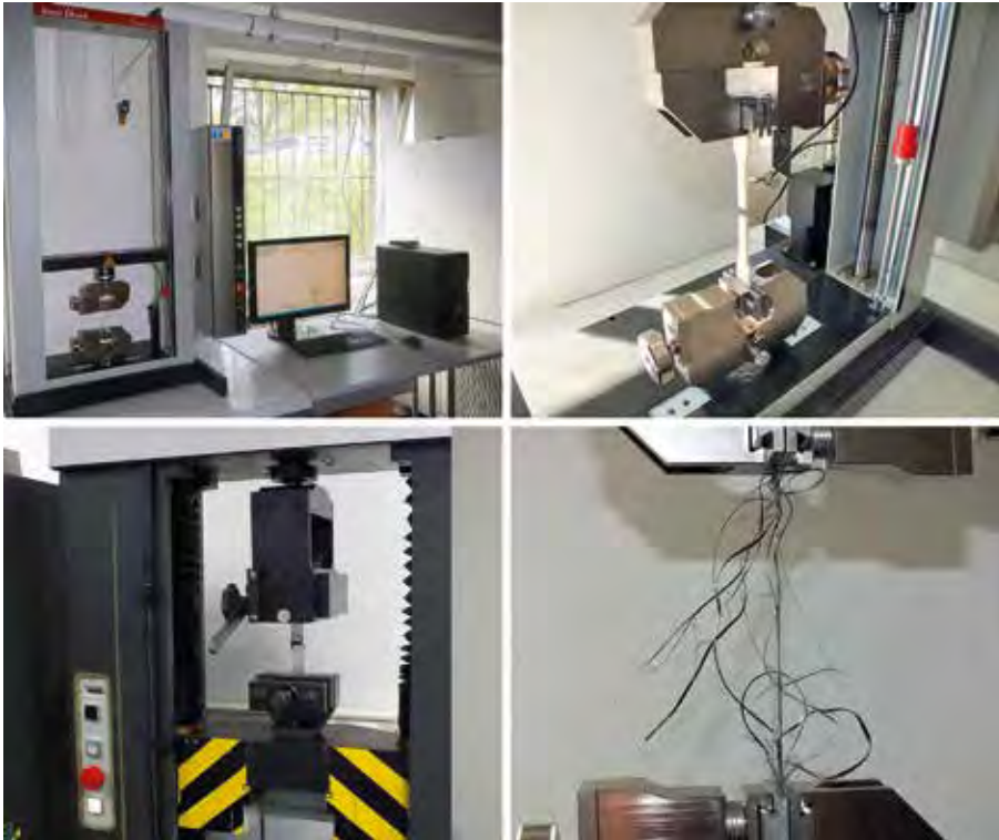
Neue Druck-Zug-Prüfanlage 10 kN (oben), 100 kN Druck-Zug-Prüfanlage Typ FPZ 100 (unten)
