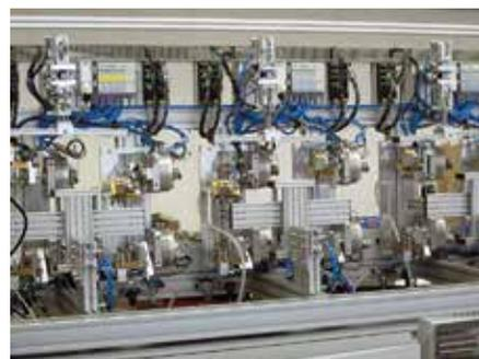
Prüflingsaufnahme mit Pneumatikantrieben
