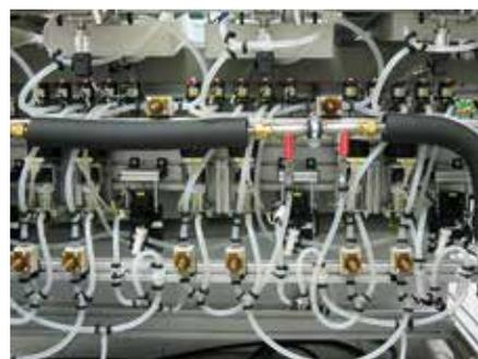
Ventil- und Dosiereinheit für verschiedene Reagenzien
