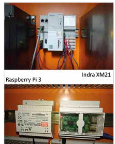
Bild 4: Einbau Indra XM21 und Raspberry Pi 3 an die Steuerelektronik der CNC-Drehmaschine
